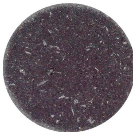
Рисунок 1 – Цифровое изображение фильтрограммы моторного масла
