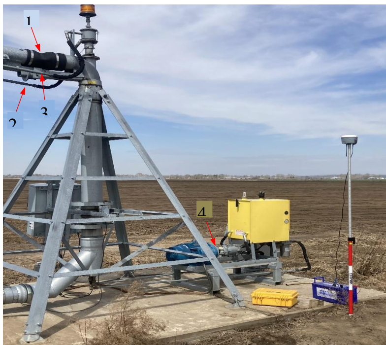
Рисунок 2 – Центральная поворотная башня и узел гидропередачи ШДМ с круговым движением фирмы T-L Irrigation company.
