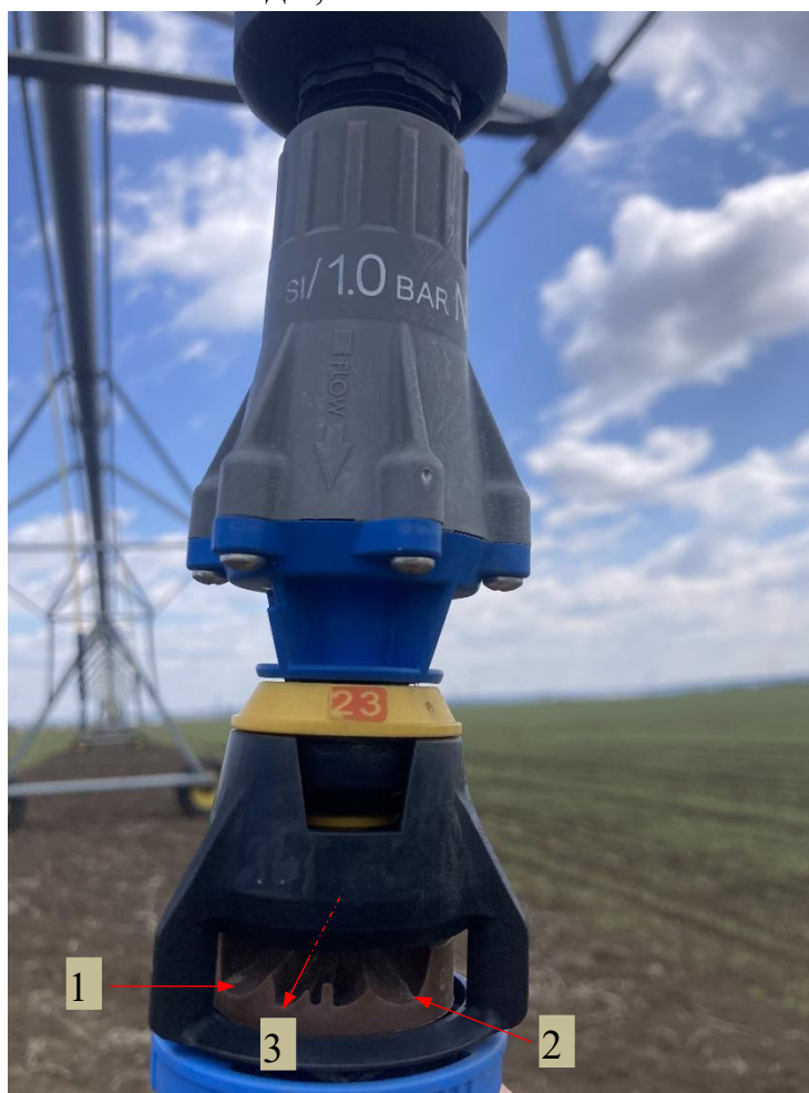
Рисунок 1 – Общий вид дождевателя фирмы Nelson D3000
